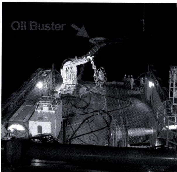
図17 流出油夜間回収作業風景
